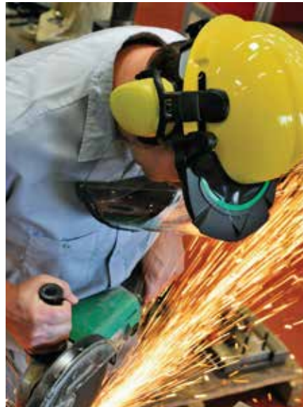
Sistema de accesorios V-Gard (portavisores y visores) utilizado en aplicaciones que demandan protección visual y a la cara contra partículas abrasivas, objetos y chispas de químicos.
