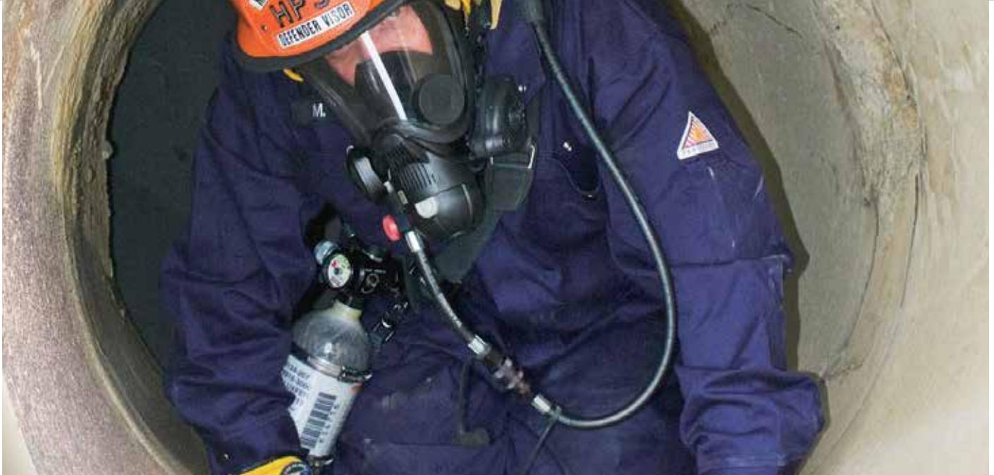
Respirador PremAire® Cadet Escape, combinación de Respirador de Suministro de Aire con Cilindro de Escape
